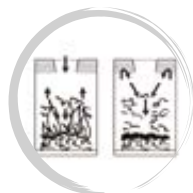
Principio di autoestinzione Flame-extinguishing process
